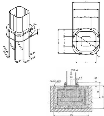
Nota: El marco de cimentación con tirafondos, utilizado en la versión de "Columna" para la fijación de la columna misma al plinto de cimentación se suministra bajo pedido. \* M= 1,11; ψ= 1,15
